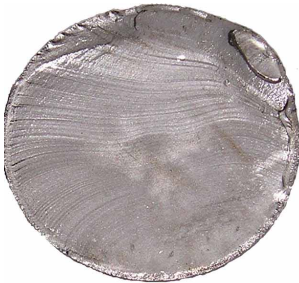
obr. 3. Únavový lom (iniciace na povrchu).
